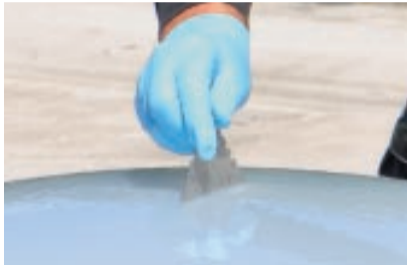
Kontrolle mit dem KEMPERTEC® V4A Messkamm.
