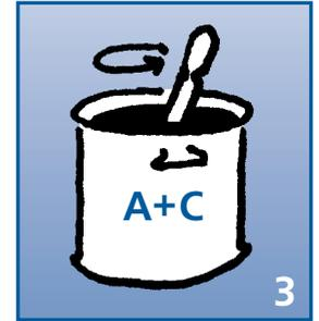
Komponente A (schwarz) und Katalysatorpulver (Komponente C) mischen. Das Mischen des Pulvers im Eimer erfolgt mit separater Bohrmaschine oder mit einem Rührholz.
