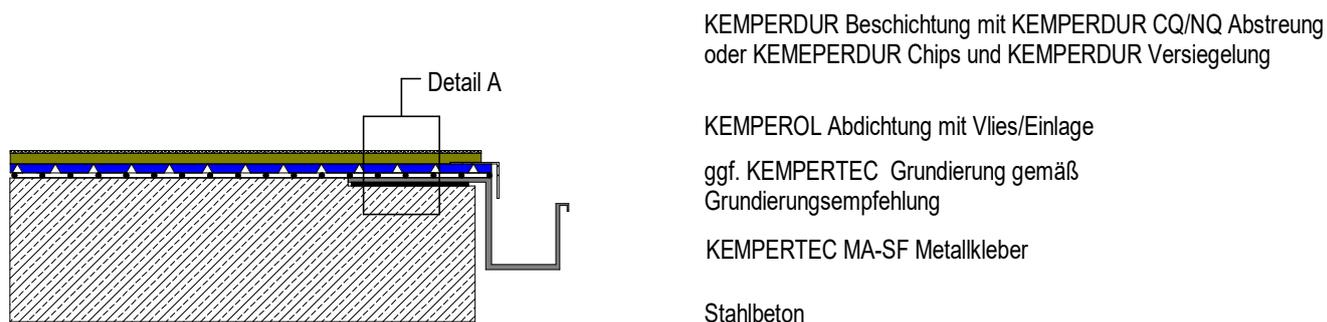
Die Zeichnung ist eine schematische Darstellung für die Herstellung einer FLK Abdichtung mit KEMPEROL als Randabschluss mit vorgehängter Rinne.
