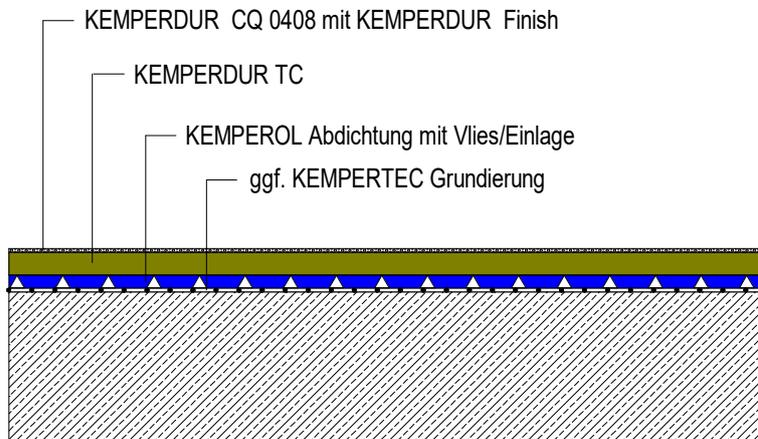
Die Zeichnung ist eine schematische Darstellung für die Herstellung einer Abdichtung mit KEMPEROL und eines Nutzbelages aus KEMPERDUR Beschichtung.
