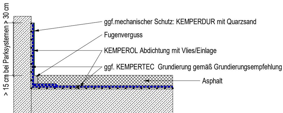
Die Zeichnung ist eine schematische Darstellung für die Herstellung einer FLK Abdichtung mit KEMPEROL unter Asphalt.
