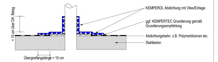
Die Zeichnung ist eine schematische Darstellung für die Herstellung einer Abdichtung mit KEMPEROL (FLK) auf Beton und Abdichtungsbahnen.
