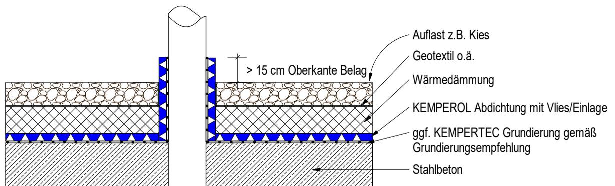
Die Zeichnungen sind eine schematische Darstellung für die Herstellung einer Abdichtung von Durchdringungen mit KEMPEROL Abdichtungen (FLK).
