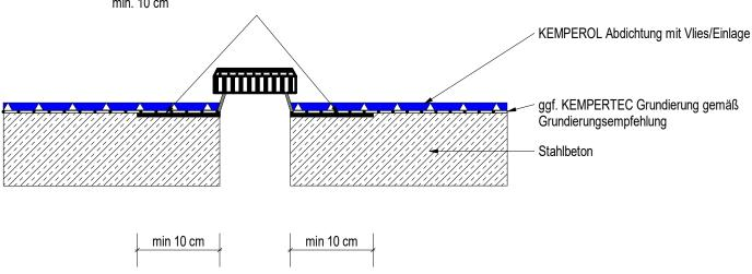
Flachdachablauf mit Flansch (Kunststoff, Bitumen, Stahl) Überlappung der Kemperolabdichtung auf dem Flansch min. 10 cm
