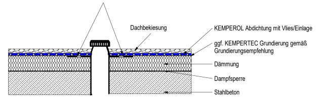
Die Zeichnung ist eine schematische Darstellung für die Herstellung einer Abdichtung mit KEMPEROL (FLK) auf Beton und Abdichtungsbahnen.
