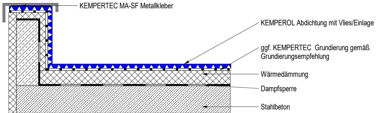
Die Zeichnung ist eine schematische Darstellung für die Herstellung einer FLK Abdichtung mit KEMPEROL unter Fliesen oder Platten.
