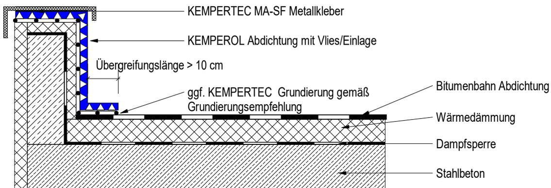
Die Zeichnung ist eine schematische Darstellung für die Herstellung einer FLK Abdichtung mit KEMPEROL unter Fliesen oder Platten.
